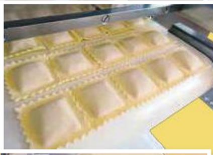
Raviolatrici per la produzione di vari formati di ravioli a doppia sfoglia, disponibili nella versione con sistema di alimentazione del ripieno tramite pistone e in continuo con pompa esterna.
